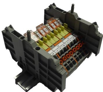
Kontrollmessungen an installierten Zählern und Messinstrumenten im Netz lassen sich mit Hilfe von Zählerprüfklemmen leicht ausführen. Diese werden vor die Zähler montiert, wodurch sich alle notwendigen Kontrollschaltungen leicht herstellen lassen. Das Abtrennen festverlegter Leitungen für den Anschluss der Prüfinstrumente fällt weg.
